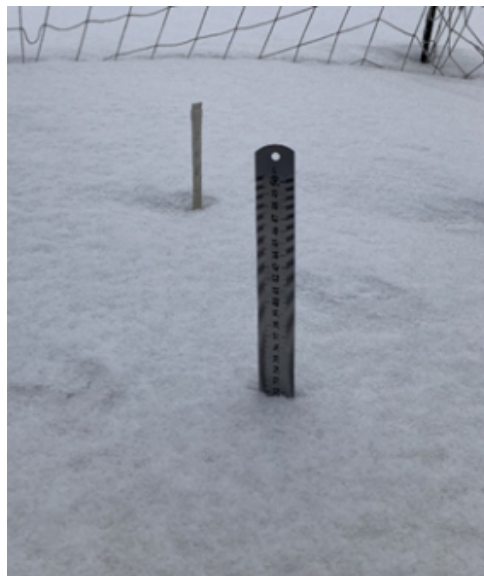
Рисунок 3. Измерительная линейка и термокоса, 10 утра 13.03.2024 года
