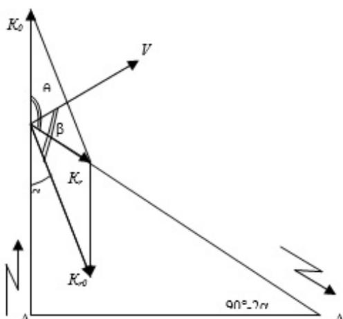
Рисунок 5 – Векторная диаграмма доплеровского локатора.
