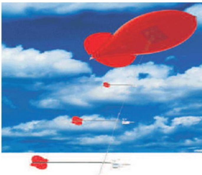
Рисунок 10 – Система аэрологического зондирования атмосферы DigiCORA Tethersonde System.
