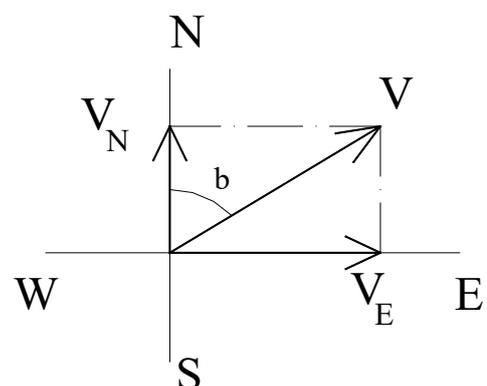
Рисунок 4 – Построение полного вектора скорости и направления ветра.
