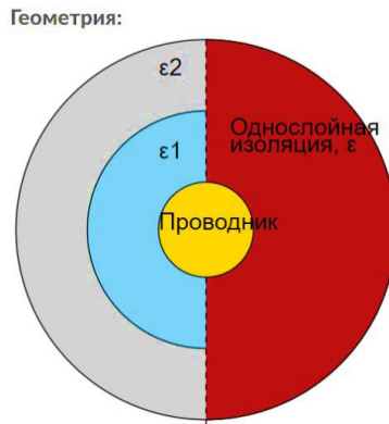
Рисунок 9. Структура комбинированной полимерно-газовой изоляции (слева) и традиционной однородной изоляции (справа) в коаксиальном промежутке
